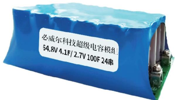
超级电容模组采用双电层电容器（超级电容 法拉电容）单体进行串联，超级电容单体内部采用活性炭作为正负电极，两极间用电解液与隔膜隔开，铝外壳与橡胶塞进行密封。本产品采用多只电容进行串联，采用FR4材质，PCB板进行组装，PCB板上集成电容过压保护电路，保护电路可以在电容两端电压超过2.65V时对电容进行保护，确保电容不被损坏。
