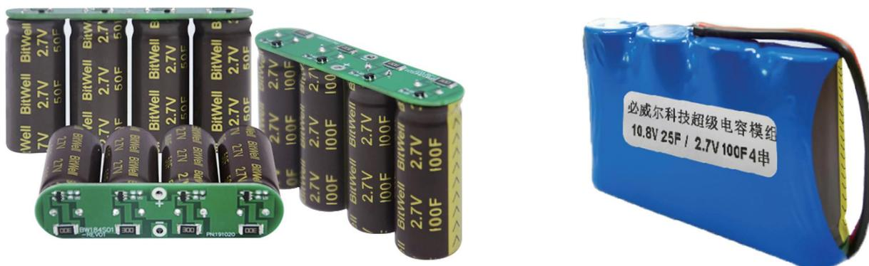
超级电容模组采用双电层电容器（超级电容 法拉电容）单体进行串联，超级电容单体内部采用活性炭作为正负电极，两极间用 electrolyte 与隔膜隔开，铝外壳与橡胶塞进行密封。本产品采用多只电容进行串联，采用FR4材质，PCB板进行组装，PCB板上集成电容过压保护电路，保护电路可以在电容两端电压超过2.65V时对电容进行保护，确保电容不被损坏。
