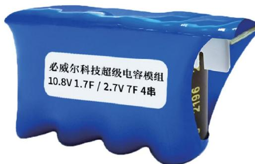
超级电容模组采用双电层电容器（超级电容 法拉电容）单体进行串联，超级电容单体内部采用活性炭作为正负电极，两极间用电解液与隔膜隔开，铝外壳与橡胶塞进行密封。本产品采用多只电容进行串联，采用FR4材质，PCB板进行组装，PCB板上集成电容过压保护电路，保护电路可以在电容两端电压超过2.65V时对电容进行保护，确保电容不被损坏。
