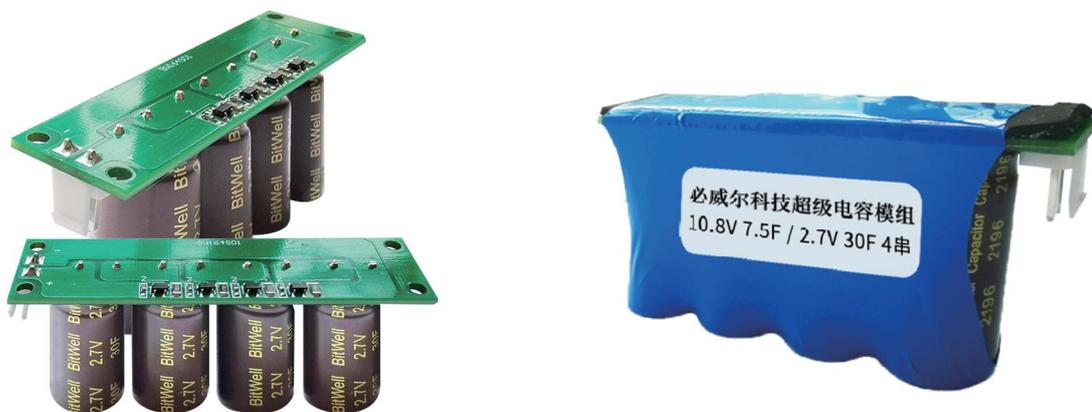
超级电容模组采用双电层电容器（超级电容 法拉电容）单体进行串联，超级电容单体内部采用活性炭作为正负电极，两极间用 electrolyte 与隔膜隔开，铝外壳与橡胶塞进行密封。本产品采用多只电容进行串联，采用FR4材质，PCB板进行组装，PCB板上集成电容过压保护电路，保护电路可以在电容两端电压超过2.65V时对电容进行保护，确保电容不被损坏。
