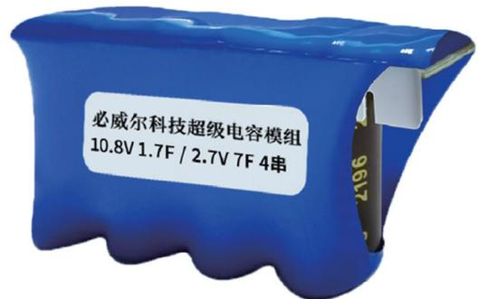
超级电容模组采用双电层电容器（超级电容 法拉电容）单体进行串联，超级电容单体内部采用活性炭作为正负电极，两极间用 electrolyte 与隔膜隔开，铝外壳与橡胶塞进行密封。本产品采用多只电容进行串联，采用FR4材质，PCB板进行组装，PCB板上集成电容过压保护电路，保护电路可以在电容两端电压超过2.65V时对电容进行保护，确保电容不被损坏。
